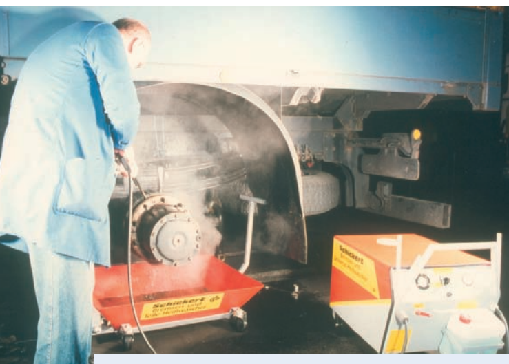
Fot.1 Uniwersalna myjka dla hamulców samochodów ciężarowych, osobowych, silników i różnych części, o symbolu 1000SC, firmy Schickert. Woda wraz z zanieczyszczeniami spływa do wanny separacyjnej o symbolu 1000SW-FP, która ją filtruje, czyniąc zdatną do ponownego użycia. (Źródło Schickert)
