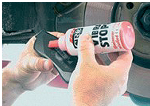
Fot.13 Nakładanie na tylną ściankę płytki nośnej klocka hamulcowego warstwy środka CRC „Disk Brake Quiet”, która po wyschnięciu utworzy elastyczną warstwę tłumiącą drgania klocka hamulcowego. (Źródło CRC)
