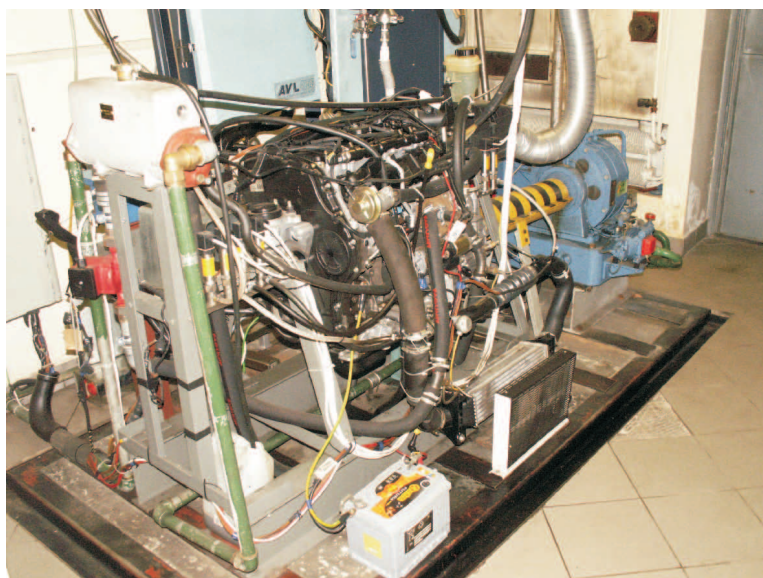
Rys. 1. Widok stanowiska badawczego z silnikiem Ford 1.8L Duratec-HE PFI FFV (125PS) MI4 [INiG]
